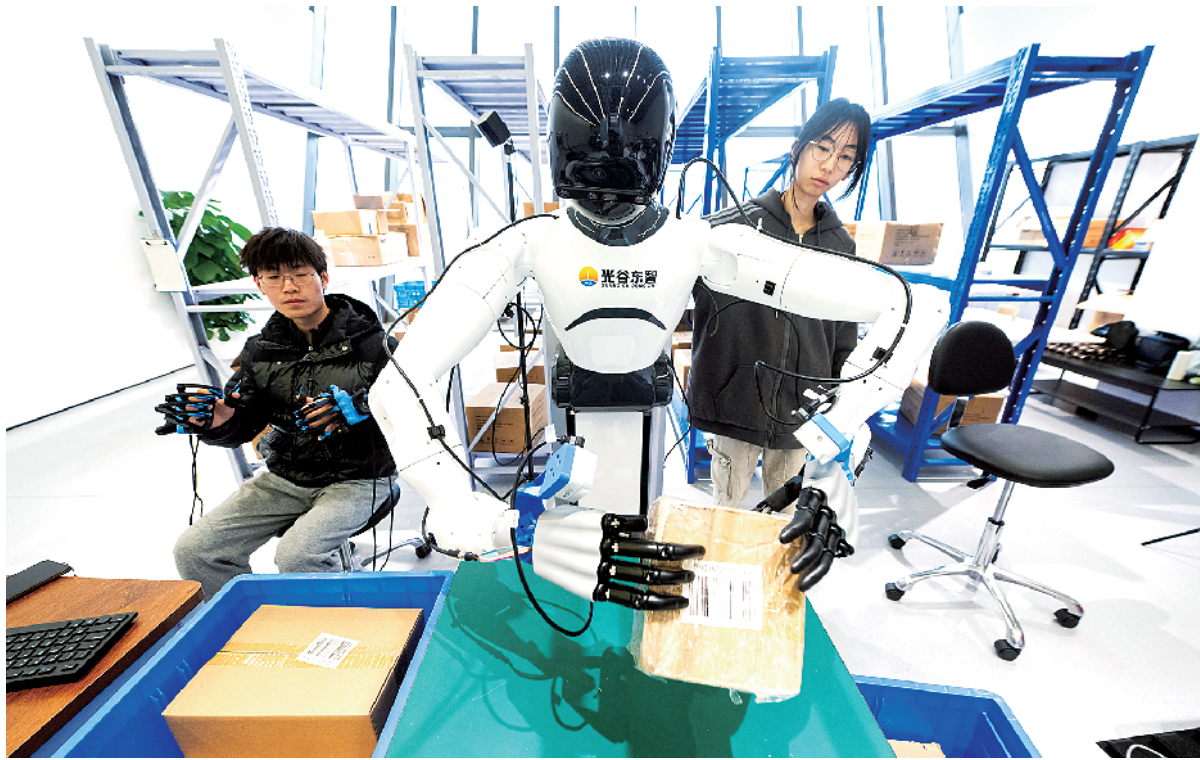
12 月 4 日,在湖北人形机器人创新中心,数据采集员操作人形机器人进行仓库搬货场景的数据采集。
